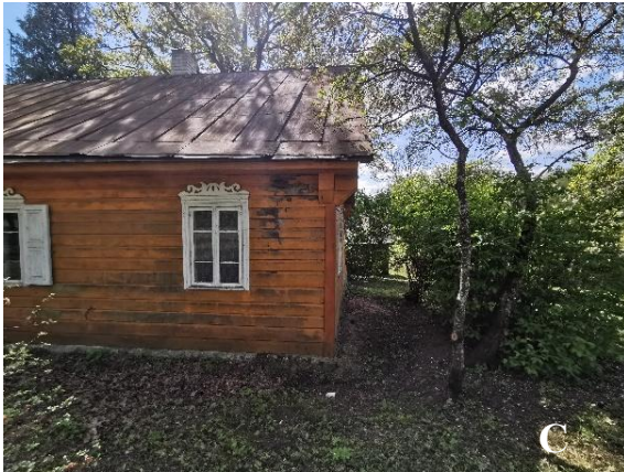
1 pav. Aplink pastatą neįrengta nuogrinda, pakilęs grunto lygis: A – pietryčių fasadas; B – šiaurės rytų fasadas; C – šiaurės rytų ir šiaurės vakarų fasadai; D – pietvakarių fasadas
